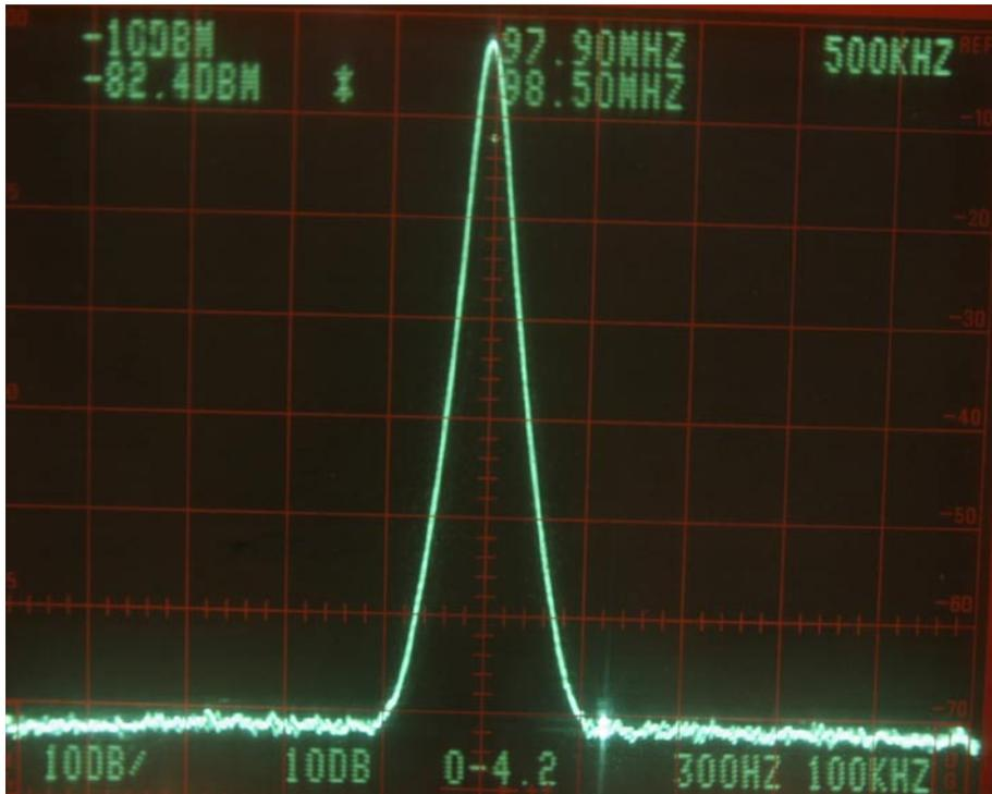
10 watts ERP (+10dBW), MINUS  $-74\text{dBm}$  =  $-64\text{ dBW}$  =  $-34\text{dBm}$
