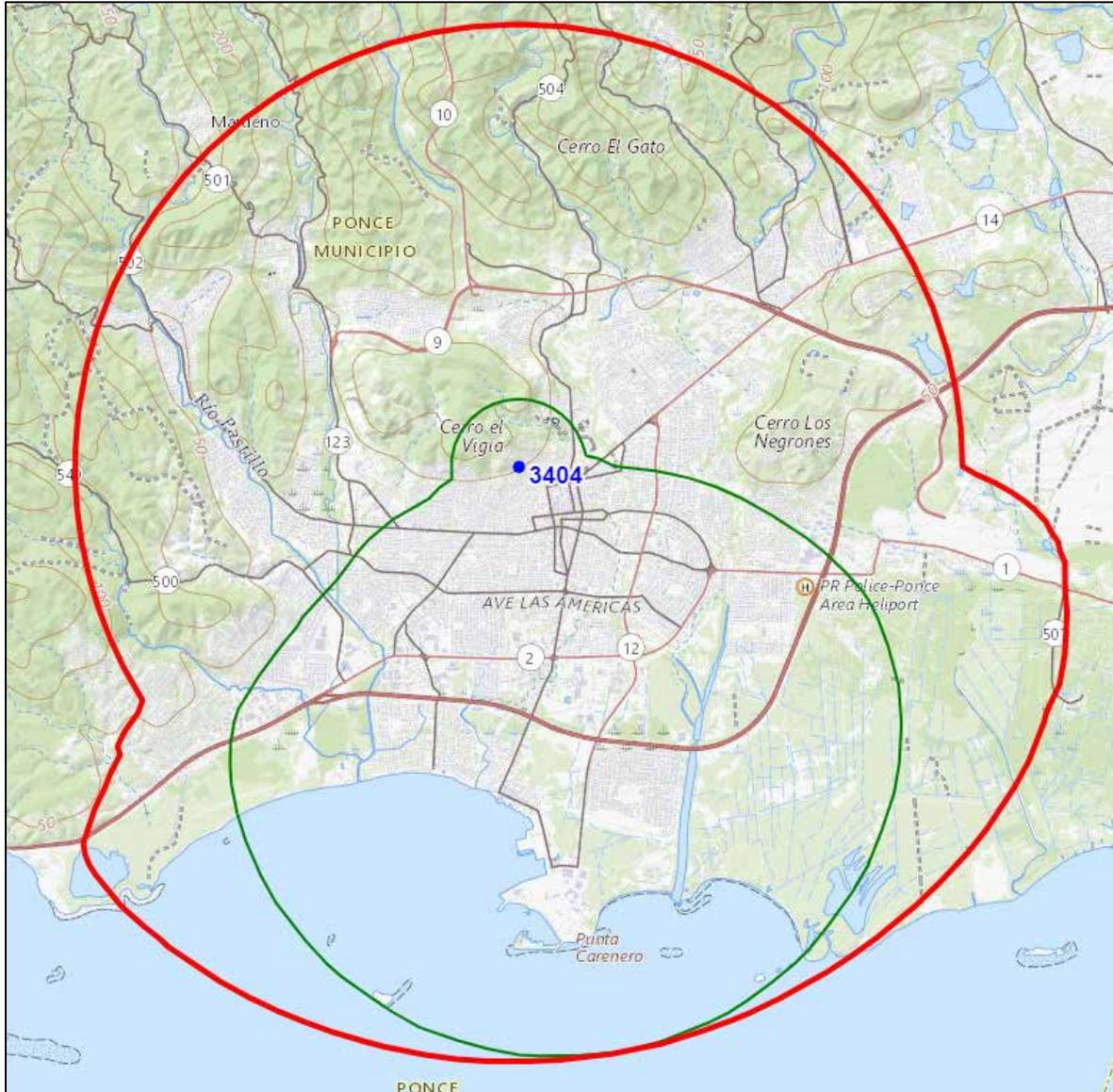
PONCE, PR ~ Channel 207LP100 (89.3 MHz) ~ ERP 0.100 kW
